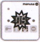
Si le programme de contrôle détecte des anomalies dans le fonctionnement de la porte, vous verrez s'afficher à l'écran un code numérique clignotant.
