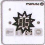
En caso de que el programa supervisor detecte anomalías en el funcionamiento de la puerta, aparece intermitente en el visualizador un código numérico.
